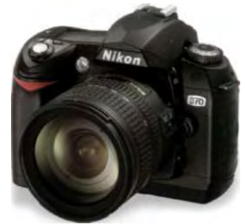
ЦИФРОВАЯ ЗЕРКАЛЬНАЯ КАМЕРА NIKON D70 Камера Nikon D 70 является типичной средней цифровой зеркальной камерой с 6,1-мегапиксельной матрицей, что позволяет получать снимок размером 3008x2000 пикселей и минимальной чувствительностью 200 ISO. Эта камера более чем адекватна в отношении качества и работы для фотографов, которые не нуждаются в снимках крупного размера и не публикуют свои работы при помощи агентств.
